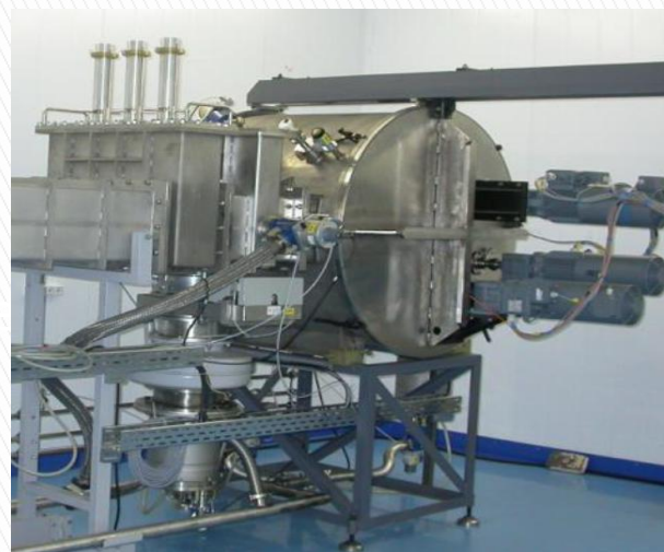
Рис.7. Установка облучения полимерных Материалов на циклотроне ИЦ-100
