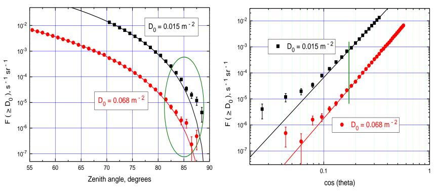
Зависимость интегральных СЛПМ от зенитного угла (слева) и от косинуса зенитного угла (справа). Линии — аппроксимации степенными функциями соѕ θ в интервале углов θ ≤ 80°.
