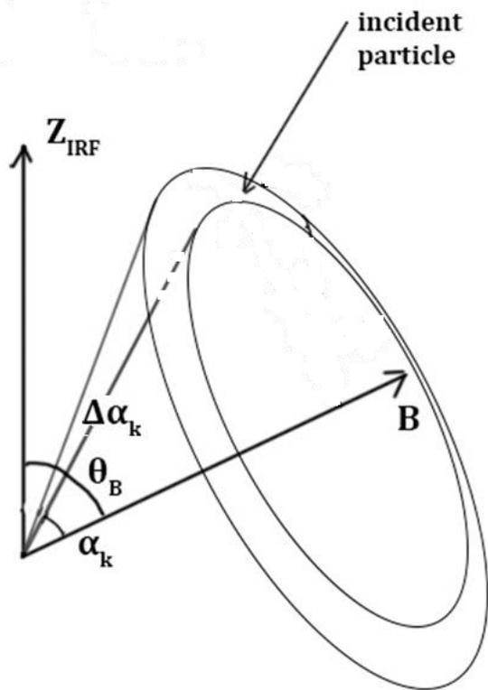
Разбиение телесного угла обзора прибора на домены
