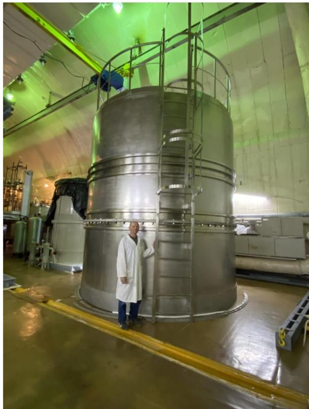
Система очистки линейного алкилбензола (ЛАБ) методом вакуумной дистилляции.
