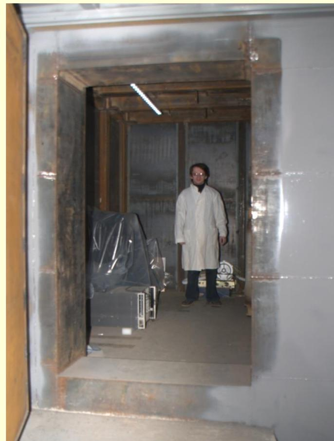
**Стены низкофоновой комнаты – 25 см полиэтилен + 0.1 см Cd + 15 см Pb**
